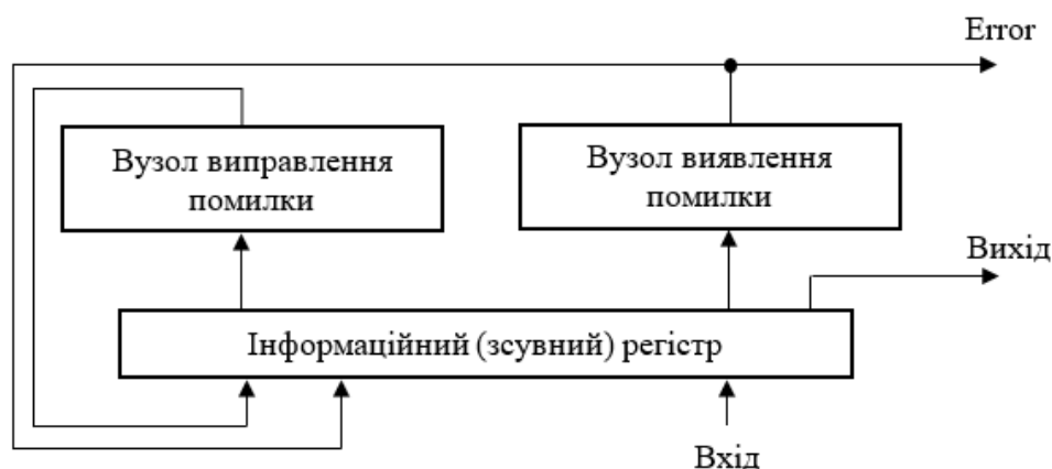
Рисунок 3 – Схема для функціонального контролю одиничного позиційного кодування
